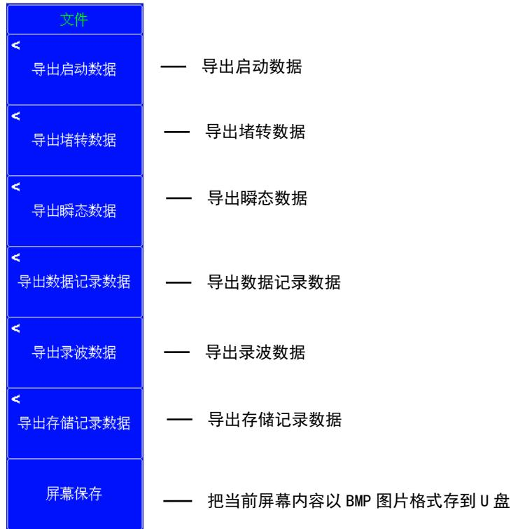
按上图中相应按键执行导出任务，导出成功后弹出如下窗口；按 SET 键确认后下面窗口消失；
