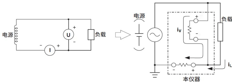
作为参考，造成影响为  $0.01\%$ 、 $0.001\%$  和  $0.0001\%$  的电压和电流关系如下图所示。
