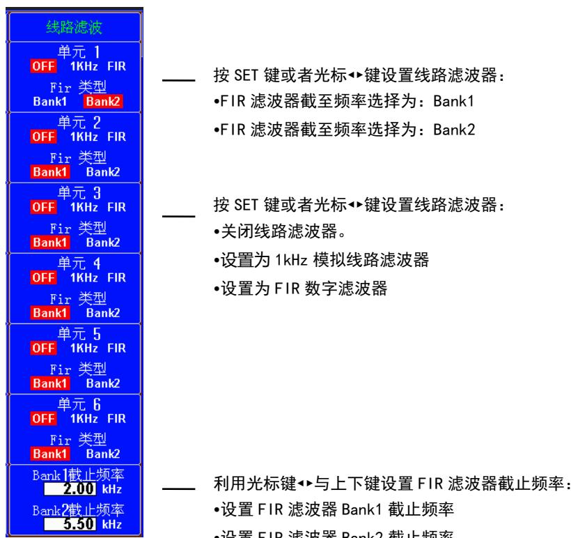
**实例：设置单元 3 的线路滤波器为 FIR 数字滤波并将截止频率设置为 Bank2**
