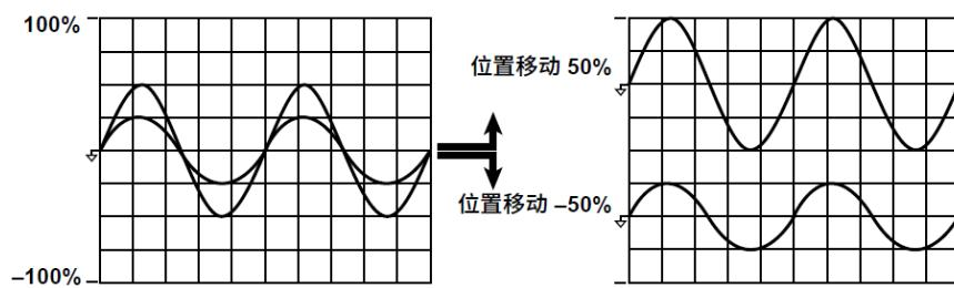
如下图所示，当缩放系数不等于 1 时，峰值因数设为 CF3 时的量程 3 倍之值（或到±100%）或峰值因数设为 CF6 时 6 倍之值（或到±100%）不在屏幕显示的上限或下限位置。在设置波形位置时必须注意缩放系数。以下是峰值因数 CF3 时的图示，电压量程 100 V，缩放系数 2，垂直位置移动了 -25%。波形移动幅度与缩放系数 1、垂直位置移动 -50% 时相同。
