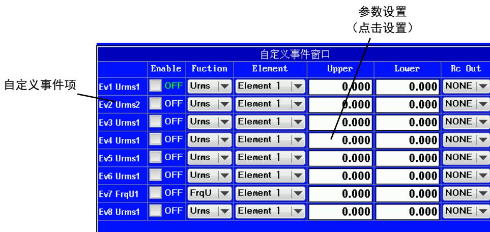
实例：自定义事件 1 设置为 Urms 单元 2 上限 30.000V 下限 10.000V 响应类型 RC1
